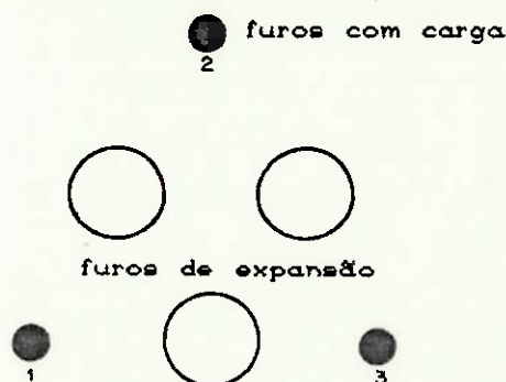
FIGURA 2.21 - Pilão cilíndrico modificado para diminuir a detonação por simpatia e dessensibilização dinâmica.
